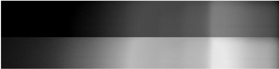
図3 電圧によるスペクトルの変化(左が短波長) 上 30V と 下 100V の比較
