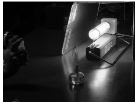
図 9 黒い炎のようす 手前においたアルコールランプの炎が黒く見えている。
