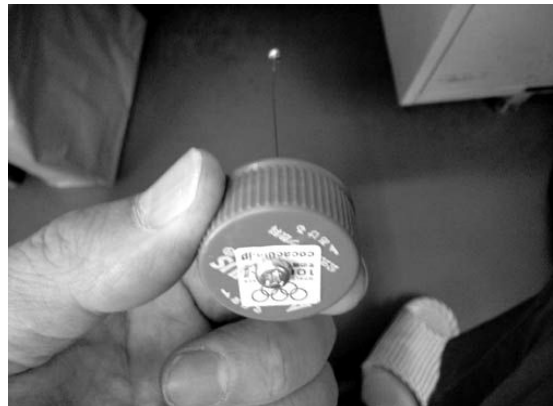
図7 木ねじでキャップに固定
