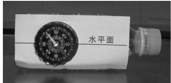
図2 ペットボトルを利用した簡易伏角計
