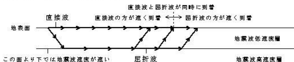
※走時曲線の傾きが変わる理由の図解例
