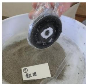
C 磁石で砂鉄を取る
